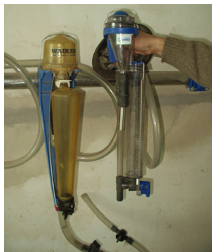
Figura 2. Principales marcas de medidores de leche mecánicos utilizados en Uruguay, Waikato® (izquierda), Tru Test® (derecha).
