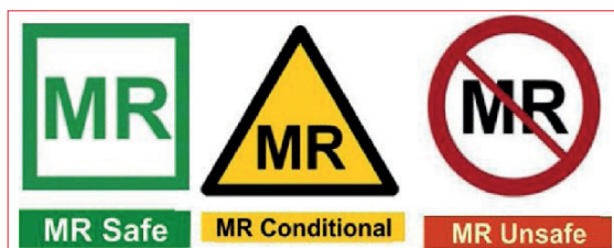
Figura 2. Logos para diferenciar los niveles de seguridad de un objeto al exponerse a una RM. Los dispositivos cardíacos implantables son condicionales o no condicionales (47) .
