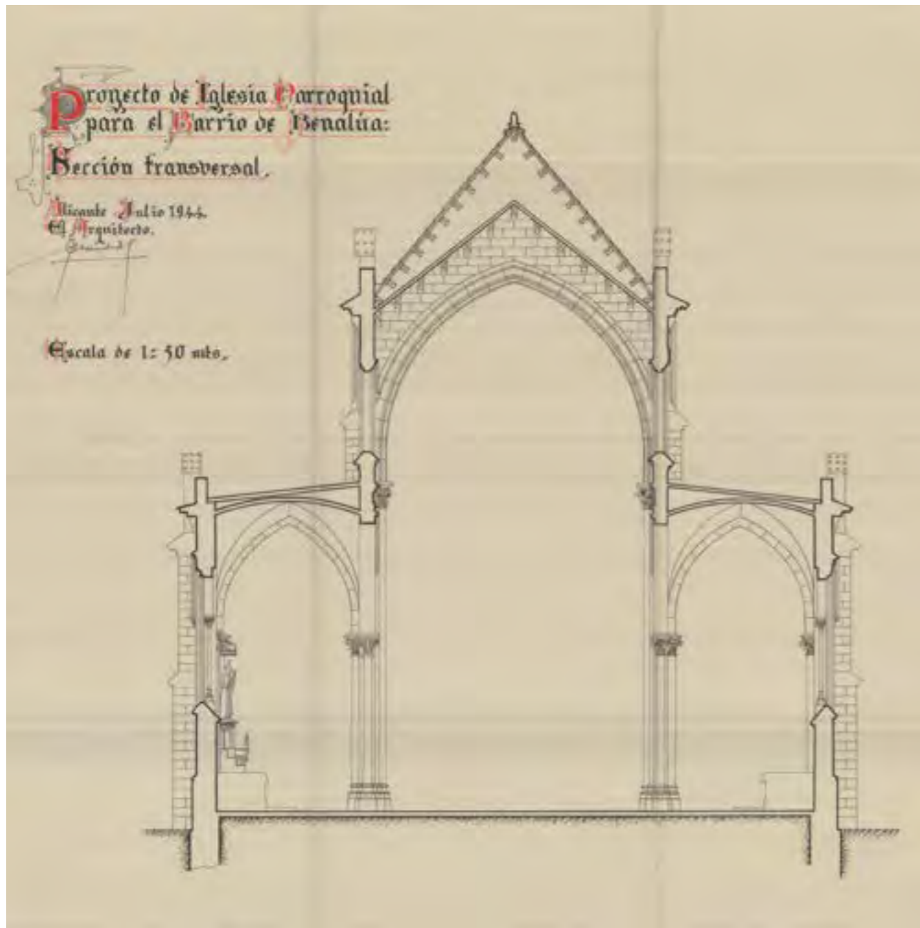
Figura 2. Sección de las naves.
