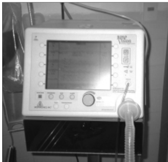
Figura 6. Equipo BIPAP VISION, fuente de suministro de O 2 , conectada a un flumiter en el aparato y que permite graduar exactamente el suministro de O 2 . Panel frontal con teclas de funciones, sensor de flujo y manguera al paciente unida al equipo a través de un filtro.
