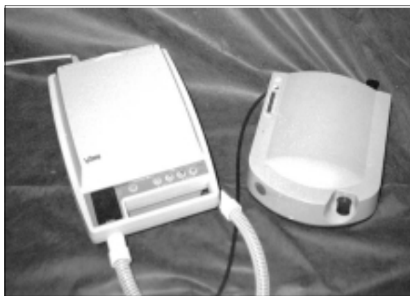
Figura 5. Equipo de BIPAP(izquierda), CPAP(derecha). El primero cuenta con botones de mando y una pequeña pantalla dónde es posible apreciar modos y cambios en el monitoreo del paciente.
