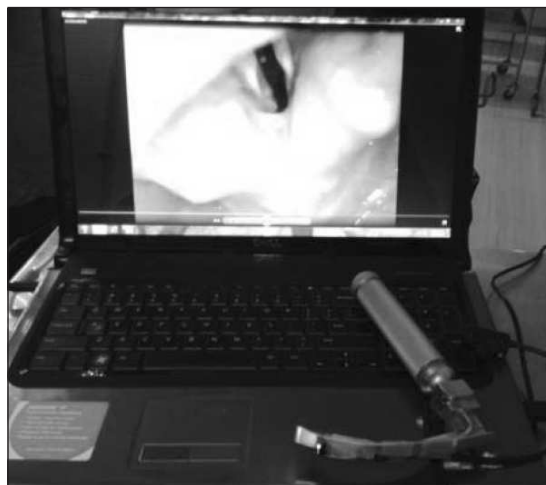
Figura 5. En esta foto se ve el laringoscopio armado con la cámara y conectado a la notebook, donde se observa una imagen grabada durante una laringoscopia realizada con este dispositivo.
