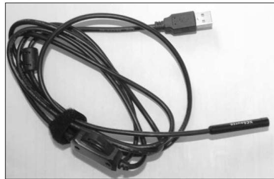
Figura 3. En esta foto vemos la cámara de 7 mm de diámetro, que tiene conexión USB para una computadora.
