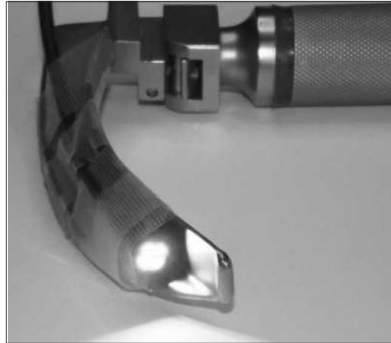
Figura 7. Cámara montada en la pala del laringoscopio con la luz encendida.
